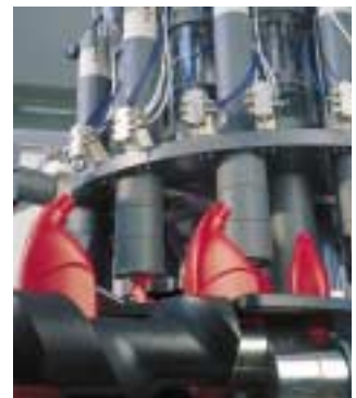
Vis sans fin en TECAST dans l'industrie du conditionnement pour avoir un fonctionnement sans à-coup.
